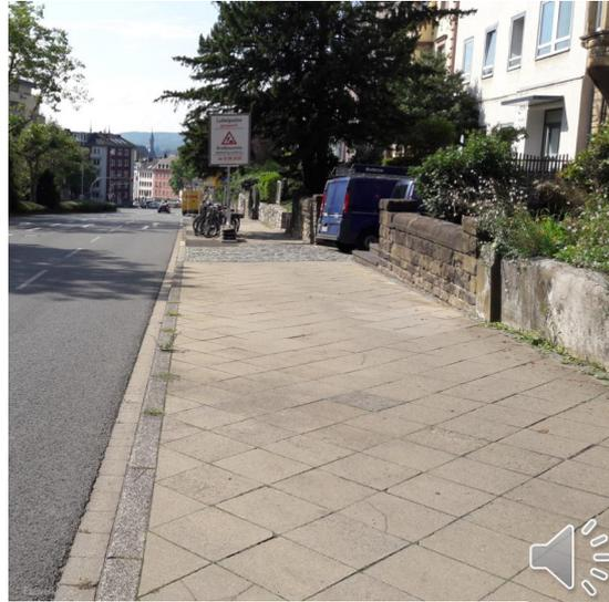
Die Bedingungen für den Fußverkehr sind insgesamt gut. Vom Soerser Weg kommend, wird der Gehweg in Richtung Bastei kontinuierlich breiter; von 2,25 m an der Elsa-Brändström Straße bis hin zu etwa 5,00 m an der Kreuzung Bastei. Das Regelmaß von 2,50 m wird also nur zu Beginn geringfügig unterschritten und an den meisten Stellen deutlich übertroffen.
