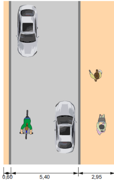
Q3 einseitiges Fahrbahnrandparken (nicht gekennzeichnet)
