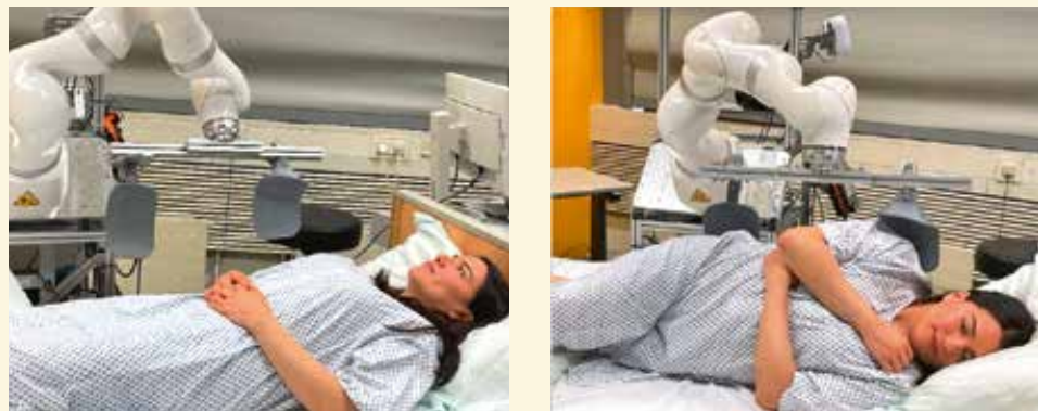
PfleKoRo – robotisches Assistenzsystem zum Drehen einer Pflegebedürftigen
