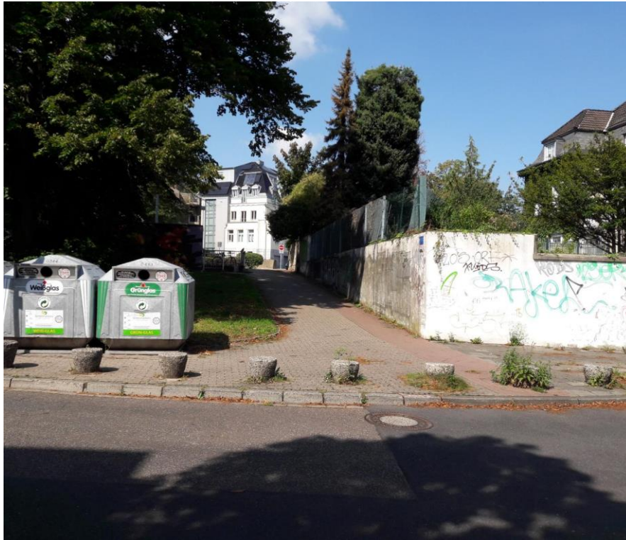
Hochbord und Betonpoller: Eingeschränkte Nutzbarkeit für Rad- und Fußverkehr
