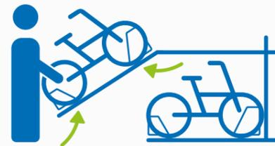
**6** Schiene am roten Griff nach oben schieben. Gasdruckfedern helfen Ihnen dabei, um den notwendigen Kraftaufwand zu minimieren.
