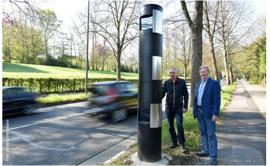
Neuer futuristischer Blitzer: Helmut Hompesch und Elmar Rosen kontrollieren die Anlage zur Geschwindigkeitsmessung an der Eupener Straße.
